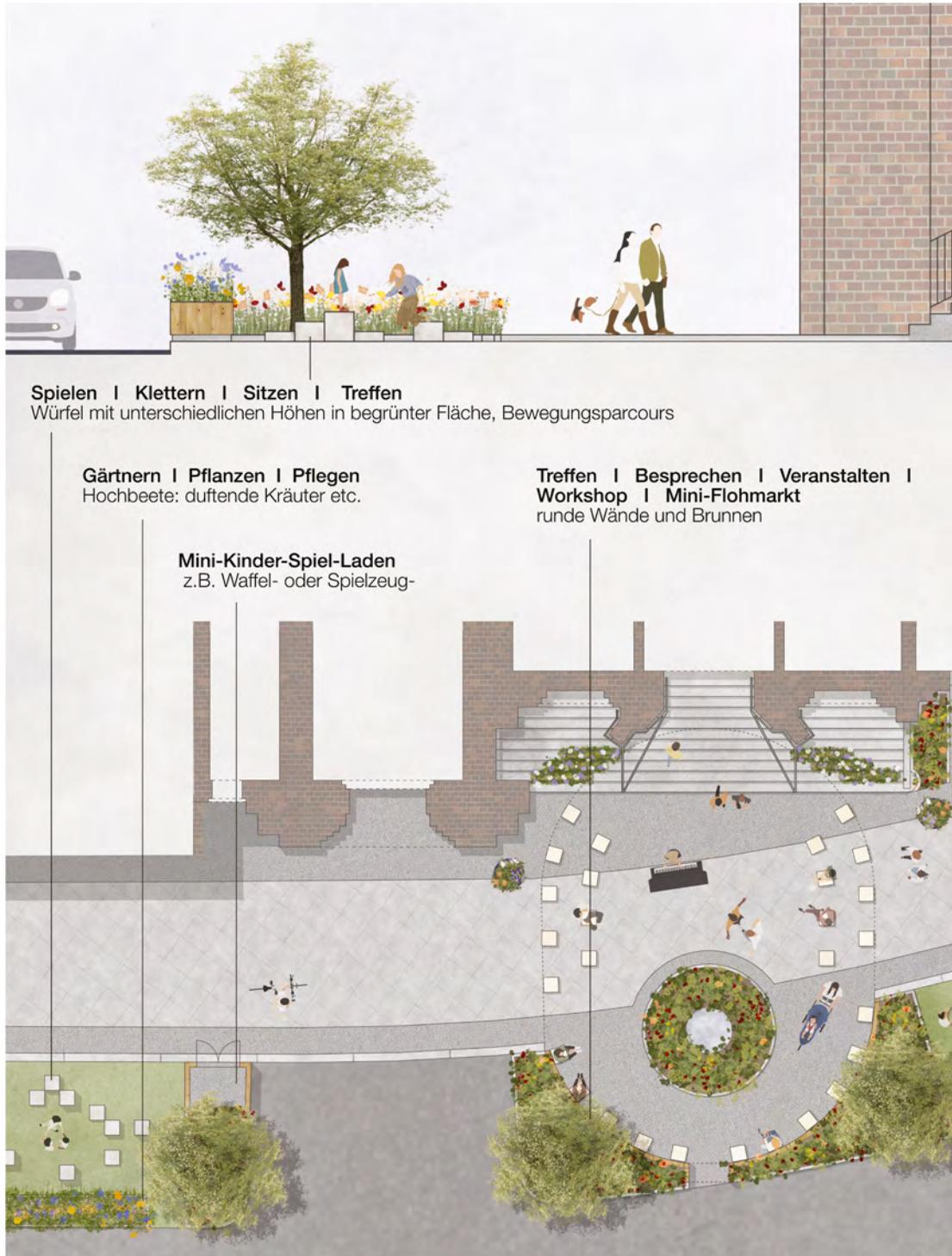
Abbildung 11.4: Grundrissausschnitt und Ansicht mit Zuordnung verschiedener Nutzungsmöglichkeiten
